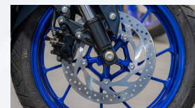
Phanh đĩa trước 2 piston 2 piston front disc brake
