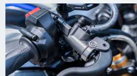
Ga điện tử với 4 chế độ lái Full APSG throttle with 4 modes
