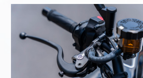
Cùm phanh Brembo Brembo master cylinders
