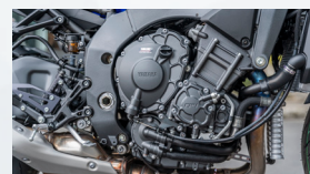
Động cơ Crossplane CP4 998cc Crossplane CP4 998cc Engine
