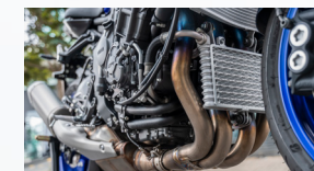
Hệ thống ống xả titanium Full titanium exhaust system
