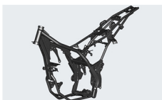
Khung sườn ống thép đôi cải tiến Innovative double cradle frame
