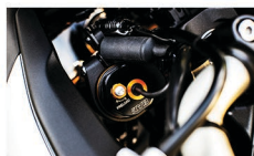
Phụộc KYB chỉnh điện trước & sau KYB electronic suspension
